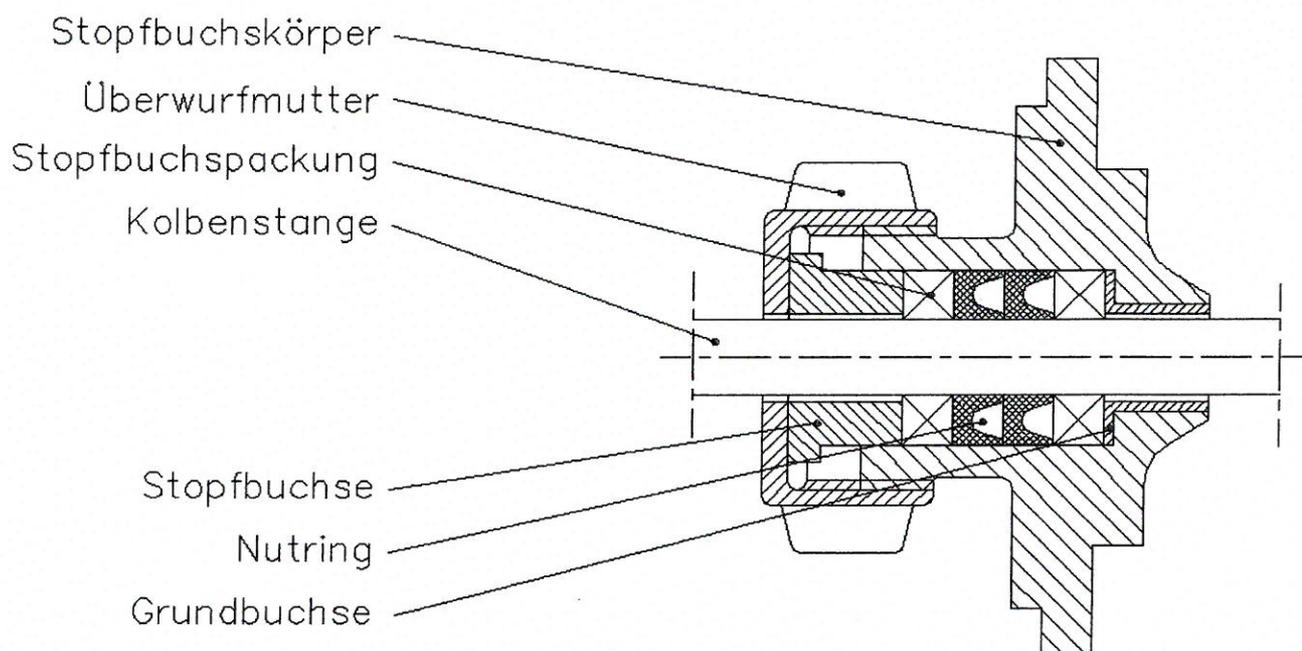
Die Stopfbuchse ist mit einer Nutringpackung versehen. Die Packung dichtet automatisch, so dass nur ein leichtes Anziehen der Überwurfmutter von Hand erforderlich ist.
